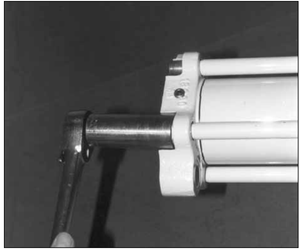
Fig. 5.3. Remove side rod nuts.
